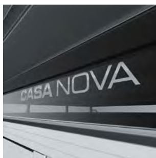
Isolerede sidevægge/dørpanel Sandwichelement med 40 mm polystyrenkerne (EPS W20)
