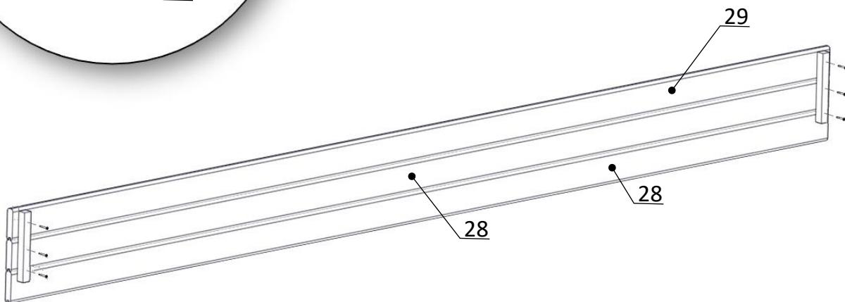
**Dwa boki:** przesunięcie listwy montażowej 30mm.
