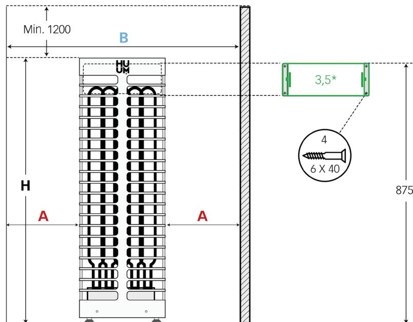
\* STEEL 3,5 крепится к стене при помощи специального кронштейна
