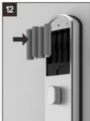
Montering af batterier
