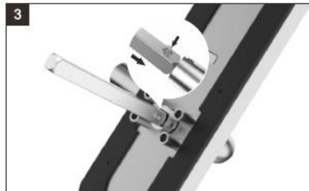
Montering af dørgrebspinden i det udvendige langskilt
