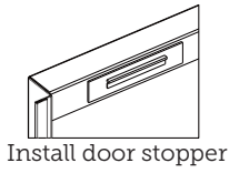
Install door stopper
